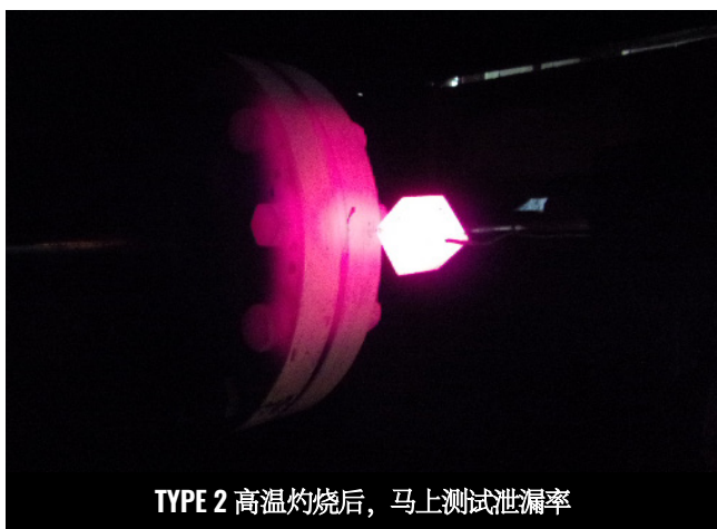
图 2 (请参考以上3 幅试验照片): API 6FB Type 2 (离岸测试)
