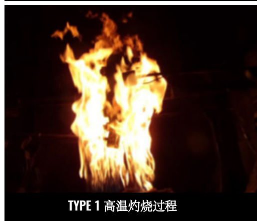
图1: API 6FB Type 1 (在岸测试) 高温灼烧开始前(上图); 高温灼烧过程(下图)
